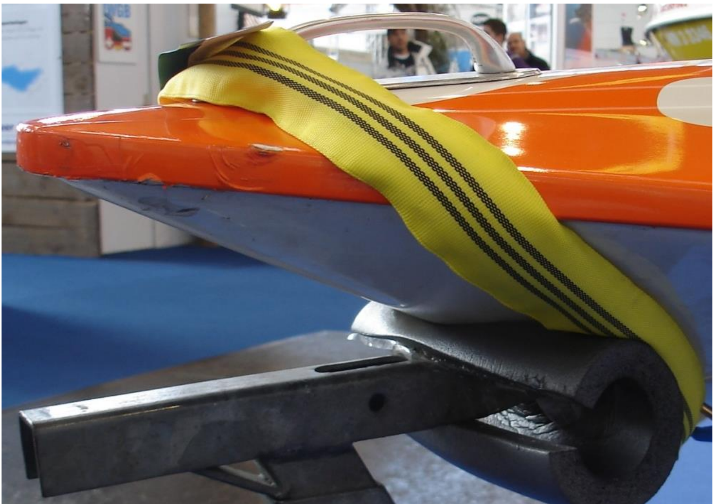
Kopfschlinge mittels Schlaufengurt
