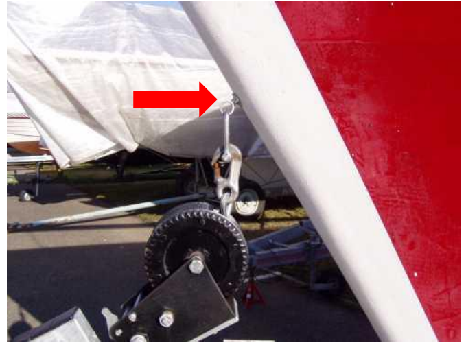
Festigkeit der Zurpunkte sorgfältig prüfen. Hier: höchstwahrscheinlich ein ungeeigneter Zurpunkt/Bug Öse.
