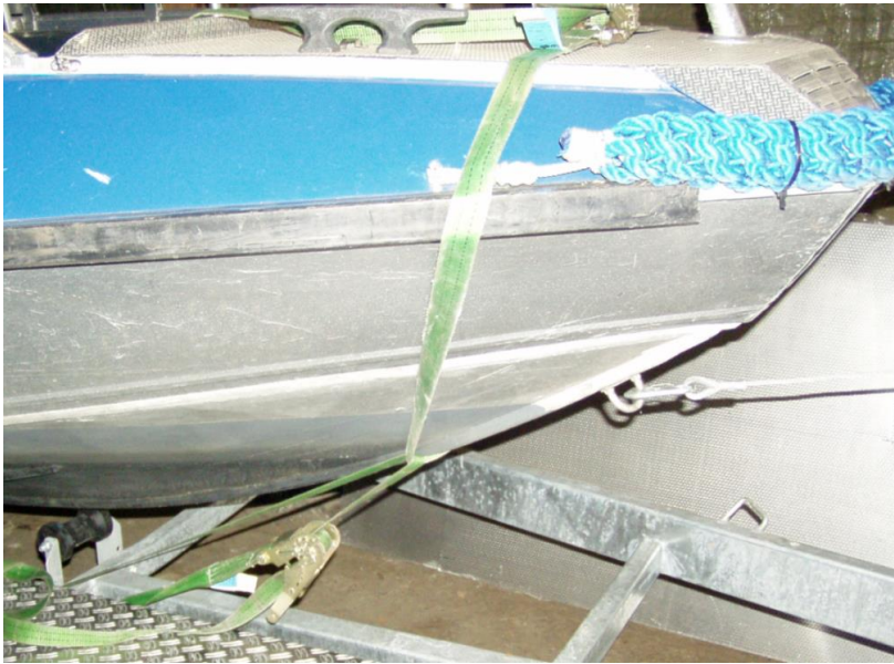
Kopfschlinge aus einteiligem Zurrurt
