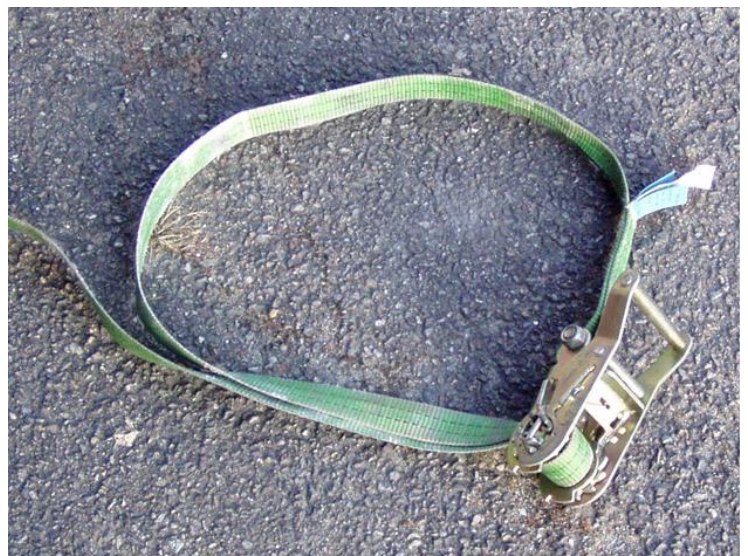
Kopfschlinge aus einem einteiligen Zurrgurt
