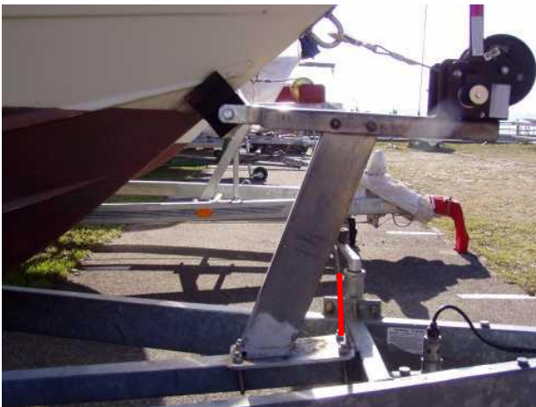
Das Widerlager dieser Bugstütze befindetet sich bis zur halben Höhe der Stütze
